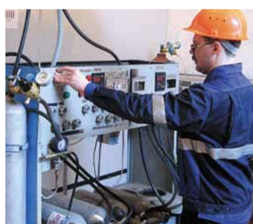
Дмитрий Пустовалов за обслуживанием установки по приготовлению поверочных газовых смесей
